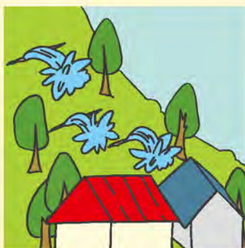
斜面から水が噴き出す。
