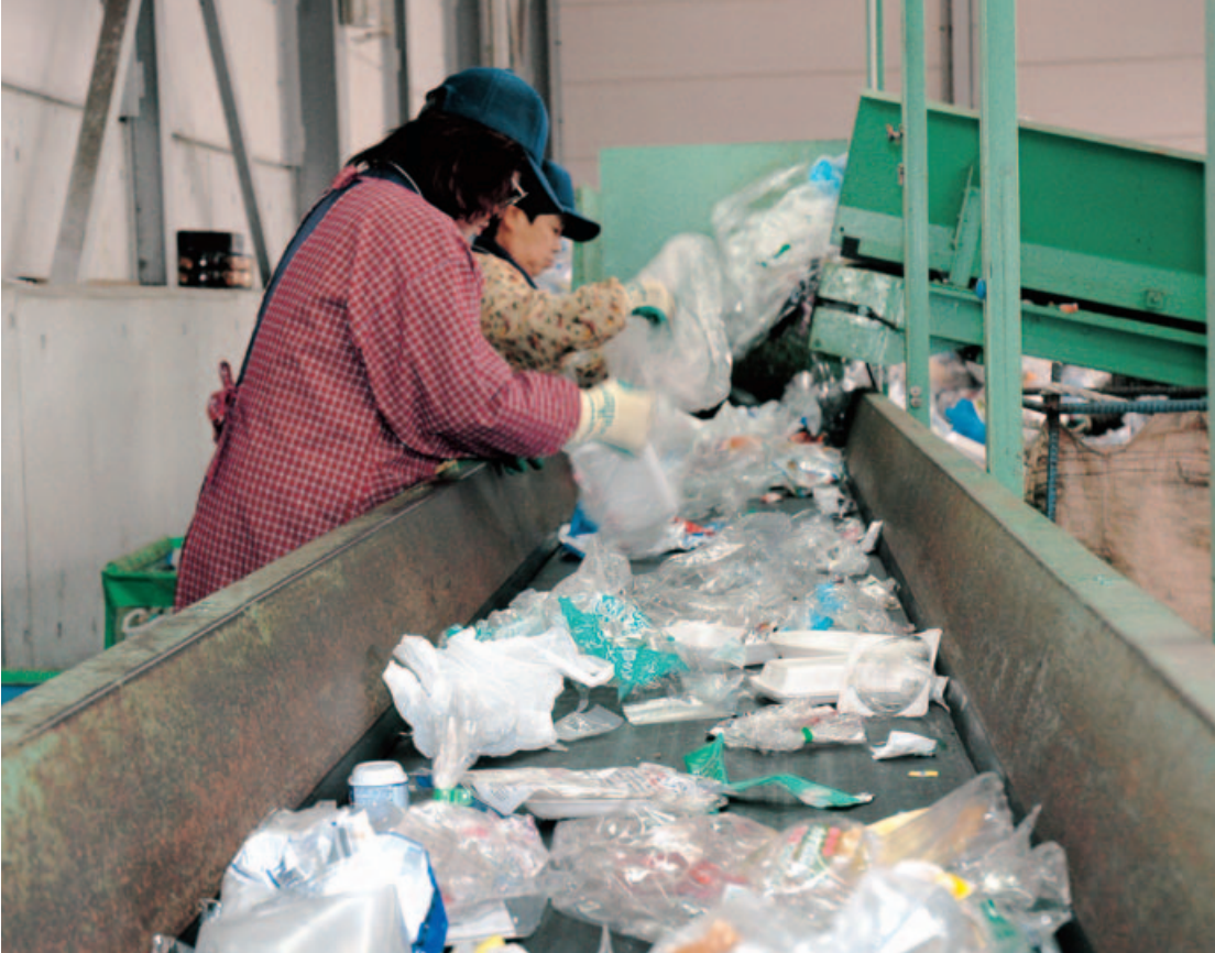
▲ 廃プラスチックの中の異物を手選別していきます
