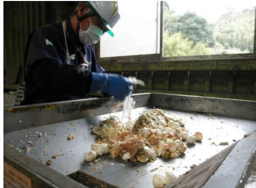
手選別により完全に異物を除去します。 生ごみに混入されているラップ類の除去作業
